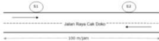
Gambar 4. Ilustrasi Penempatan Surveyor Survei Hambatan Samping
