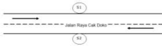
Gambar 2. Ilustrasi Penempatan Surveyor Survei Volume
