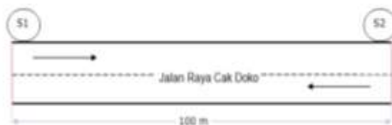
Gambar 3. Ilustrasi Penempatan Surveyor Survei Kecepatan
