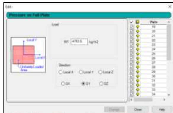
Gambar 6 : Menu Input Beban Hidrostatis (Beban File Cap )
