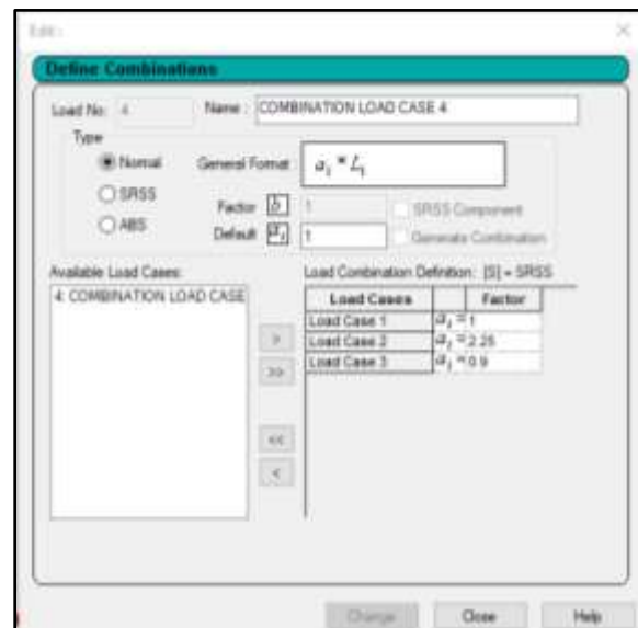
Gambar 6 : Menu Input Beban Hidrostatis (Beban File Cap )
