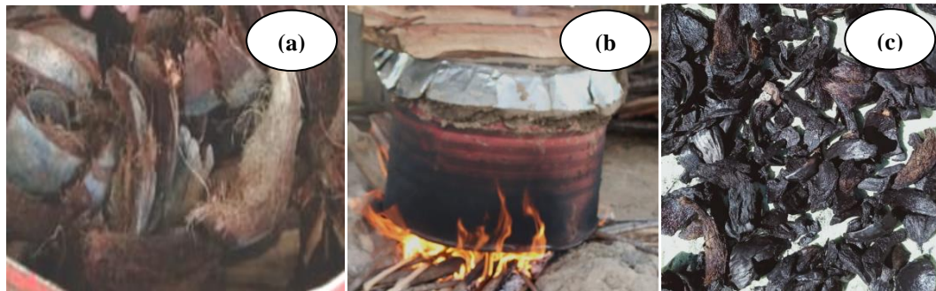
Gambar 1. Proses pembuatan biochar . a). Bahan organik sabut kelapa; b). Tahapan karbonisasi \pm 3 jam; dan c). Biochar . Lokasi: Desa Oel'ekam kecamatan Mollo Tengah kabupaten Timor Tengah Selatan (Dok. Pelaksana, 2020).
